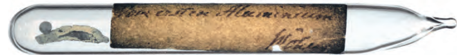
1845 gelang es Friedrich Wöhler erstmals, einige stecknadelkopfgroße Aluminiumkügelchen zu erhalten, wodurch er die Dichte des Metalls bestimmen konnte. Die Beschriftung des Röhrchens stammt von Wöhler selbst. Foto: Deutsches Museum.
