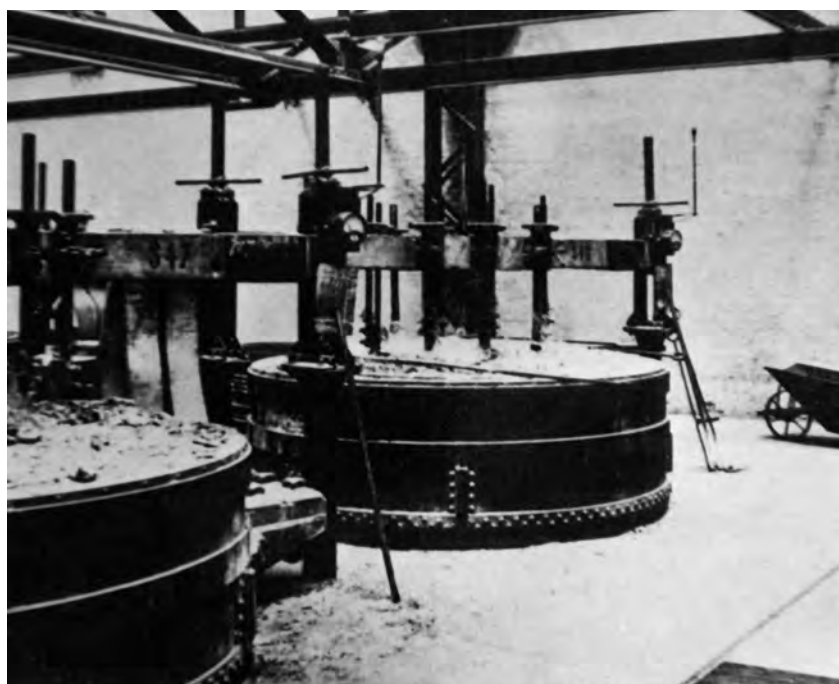
Aus den Anfängen der Aluminium-Elektrolyse: zwei Sechs-Anoden-Zellen mit einer Stromstärke von 5.000 Ampere nach einer erneuerten Konstruktion Paul Héroults im Jahr 1894. Foto: Bernard Langerock.
